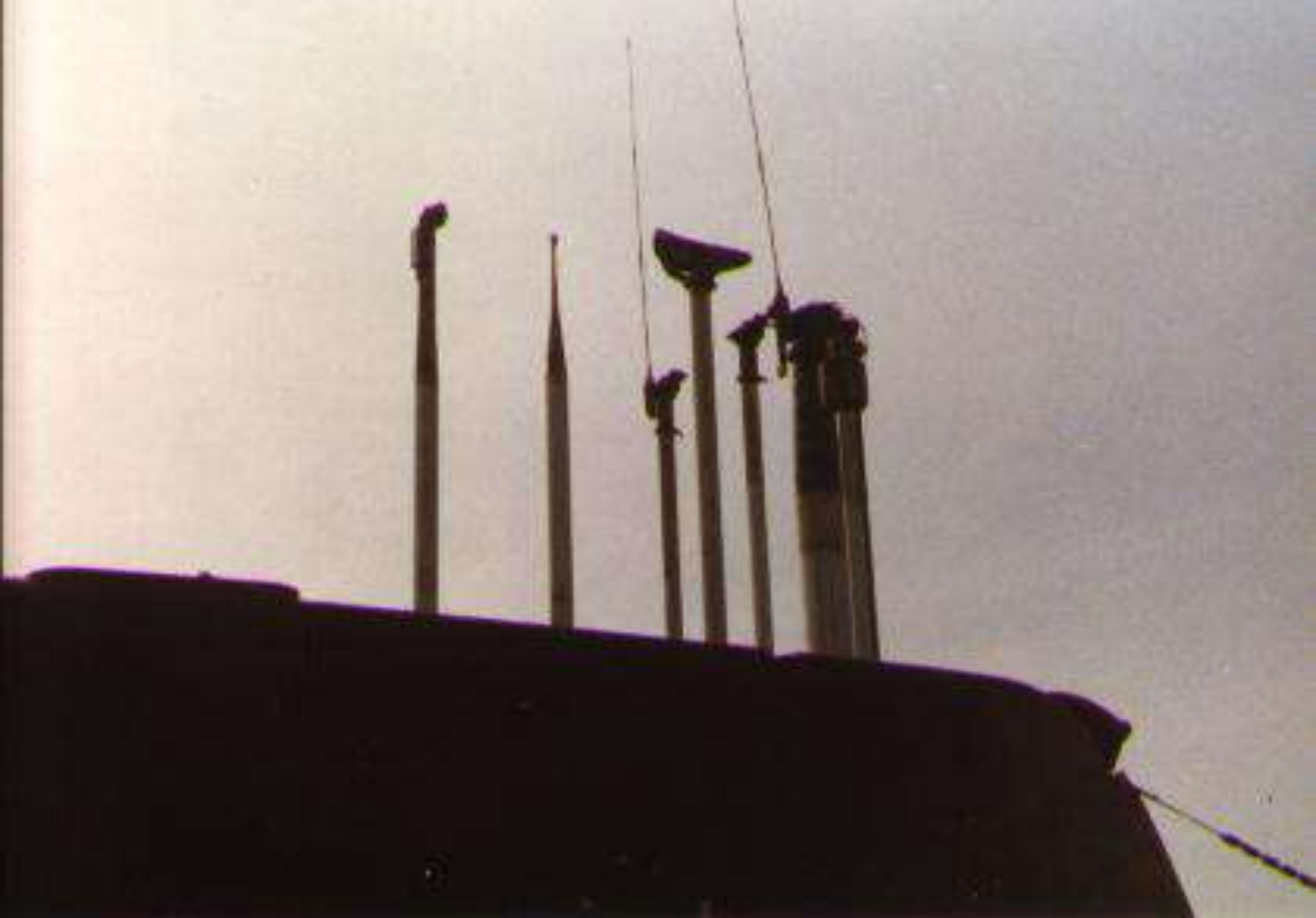
Les aériens du SM (périscopes, antennes, radar, snorkel, etc.)
